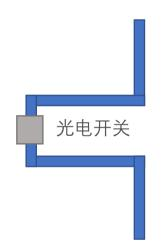
光电开关立柱改变形状, 牛够 不到
